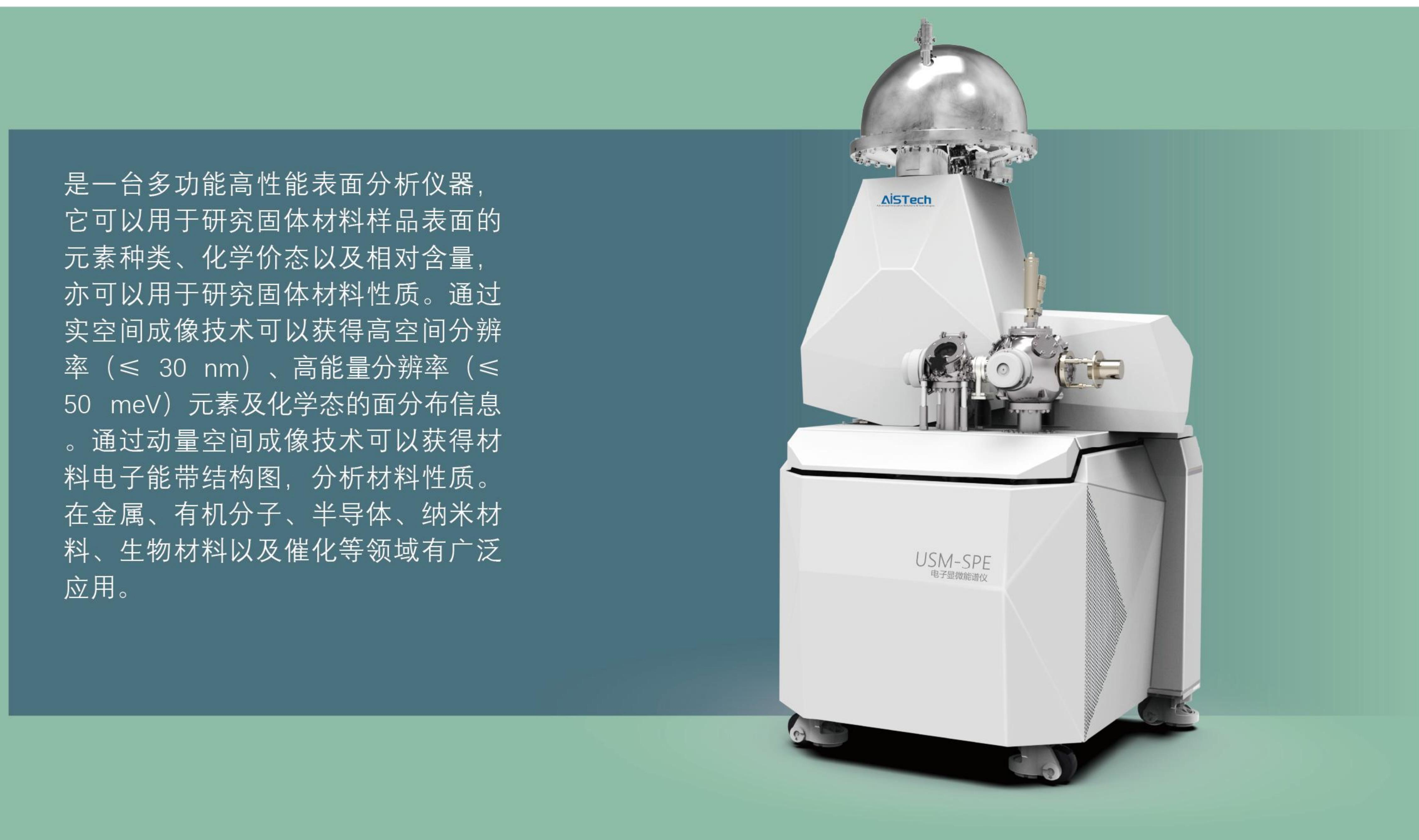
是一台多功能高性能表面分析仪器，它可以用于研究固体材料样品表面的元素种类、化学价态以及相对含量，亦可以用于研究固体材料性质。通过实空间成像技术可以获得高空间分辨率（ $\leq 30 \text{ nm}$ ）、高能量分辨率（ $\leq 50 \text{ meV}$ ）元素及化学态的面分布信息。通过动量空间成像技术可以获得材料电子能带结构图，分析材料性质。在金属、有机分子、半导体、纳米材料、生物材料以及催化等领域有广泛应用。
